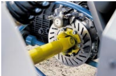
Eigenbau: das Fahrwerk mit Doppelquerlenkern, Gewindefahrwerk und 35 mm Federweg (o.). Innenliegend: Scheibenbremsen vorn und hinten (u.)
