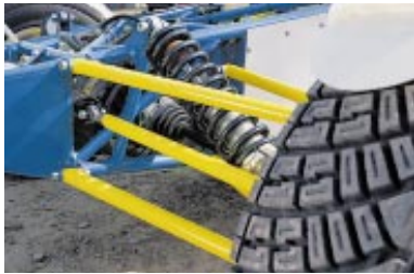
Eigenbau: das Fahrwerk mit Doppelquerlenkern, Gewindefahrwerk und 35 mm Federweg (o.). Innenliegend: Scheibenbremsen vorn und hinten (u.)
